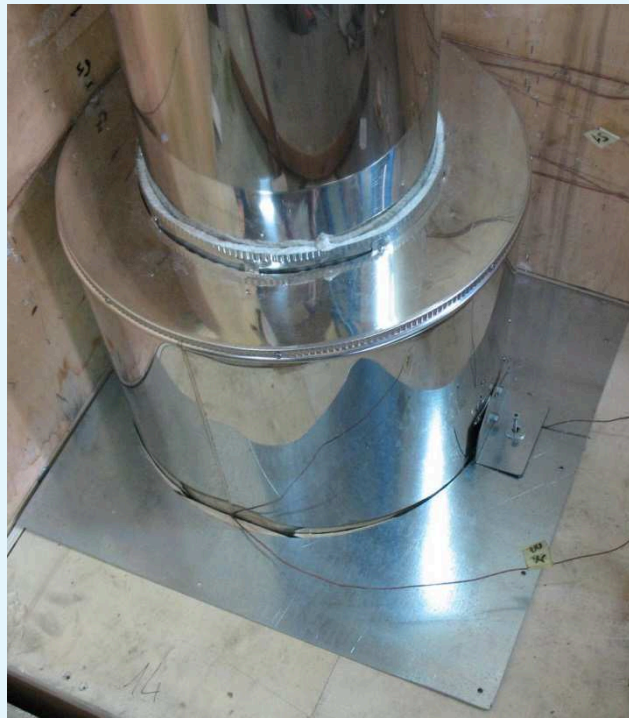
Piano superiore (con lamiera e corda fibraceramica)
